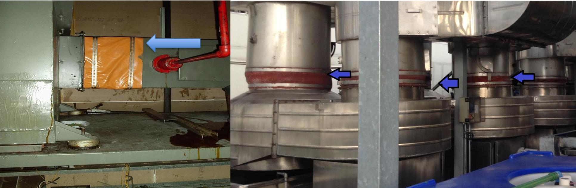
Uso inadecuado de flexibles combustibles externaliza llama, utilizar fibra cerámica con silicona de alta temperatura
